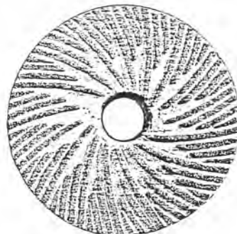
a Mahlstein (zum Schroten) b Kunststein c Liezer (ohne Häuel) d Bogenscharte (gebogene Felderscharte) e linksstehend
